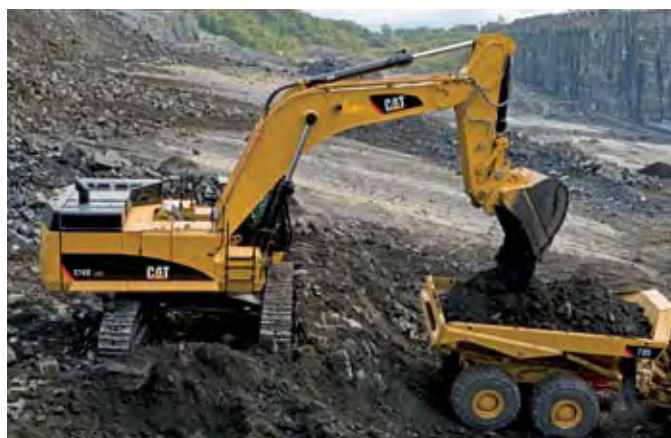
Escavadeira 374D, de 71 t, ganhou mais potência no motor e na hidráulica
