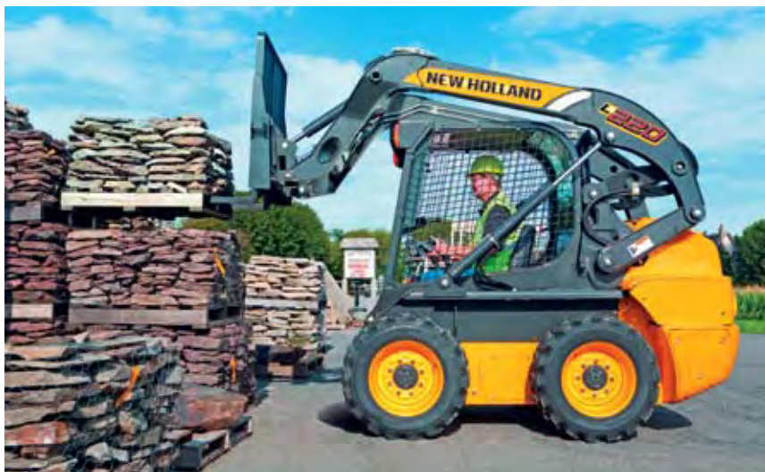
New Holland lançou a série 200 de skid steer, com sistema patenteado de elevação vertical Super Boom, que despeja no centro do caminhão
