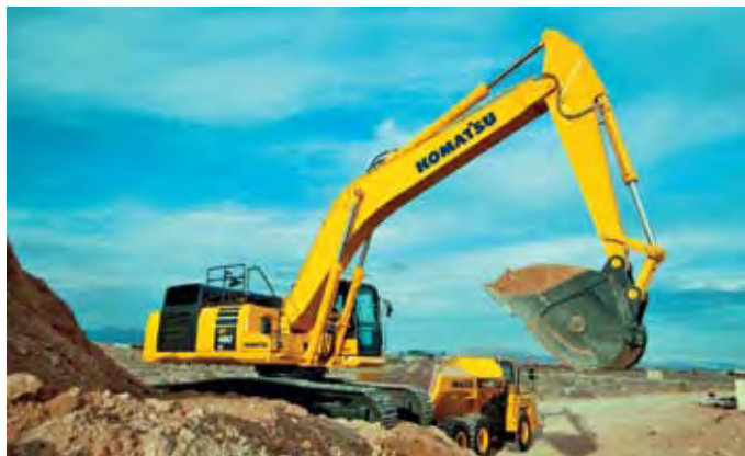
Escavadeira PC490LC-10, de 49t, 359 HP, sistema hidráulico montado com componentes de fabricação própria
