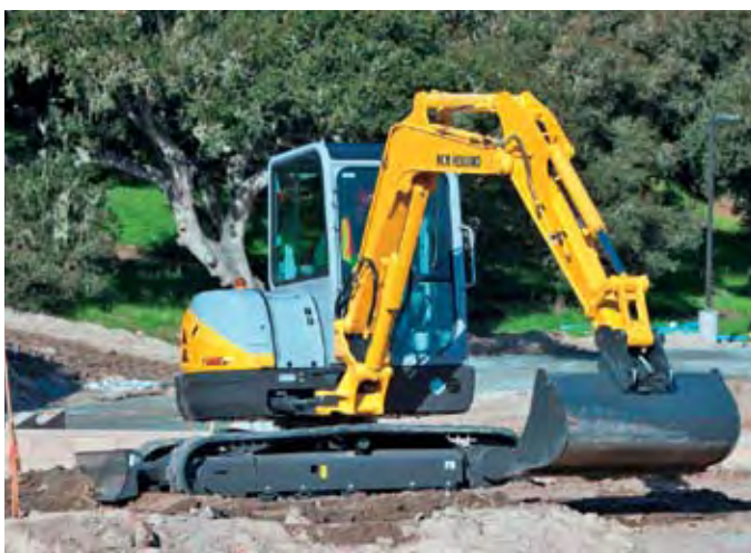
Escavadeira compacta E55Bx da New Holland, de 5,5 t, alcance de 3,9 m em profundidade, lâmina dozer standard
