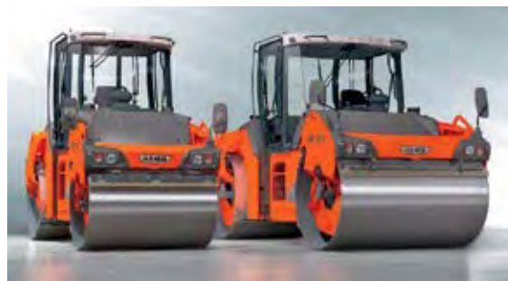
Rolos tandem de 1,67m - HD 110, de 11,5 t, e HD90, de 10 t, com escolha de vibração convencional, oscilante, alta compactação de 4000 vpm, combinação de dois sistemas, além de rolo partido. Embaixo, a cabine do operador
