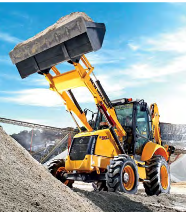
Nova série B de retroescavadeiras, com 6 modelos, motor turbo de 95 a 108 HP, sistema hidráulico de volume variável, lança traseira de perfil curvo que proporciona maior força de escavação
