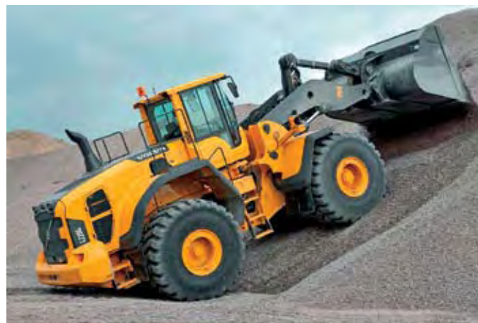
Bastam 2 ciclos da carregadeira Volvo L220G para encher um caminhão
