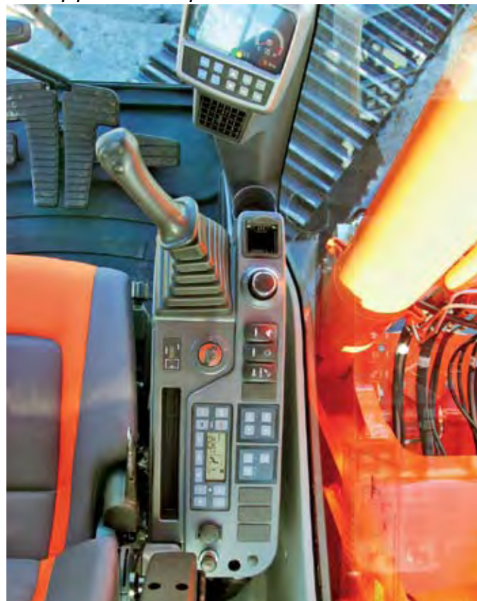
Cabine equipada com ROPS e painel de controle redesenhado
