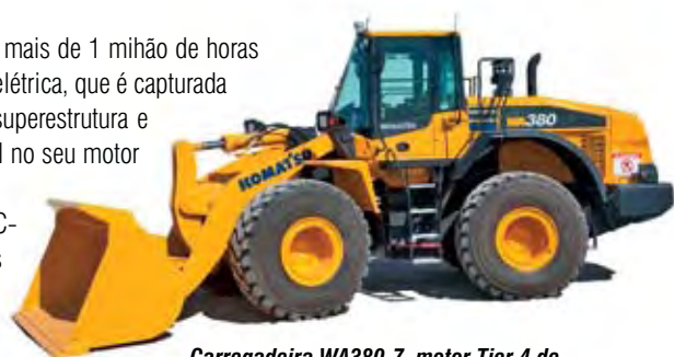
Carregadeira WA380-7, motor Tier 4 de 191 HP que consome 10% menos de diesel, sistema SmartLoader que reduz o torque quando a caçamba está vazia
