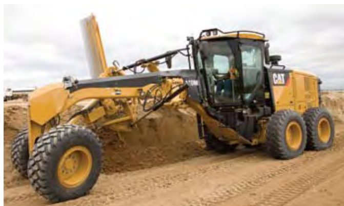
Motoniveladora 140M2 usa joystick eletrônico que eliminou movimentos manuais repetitivos
