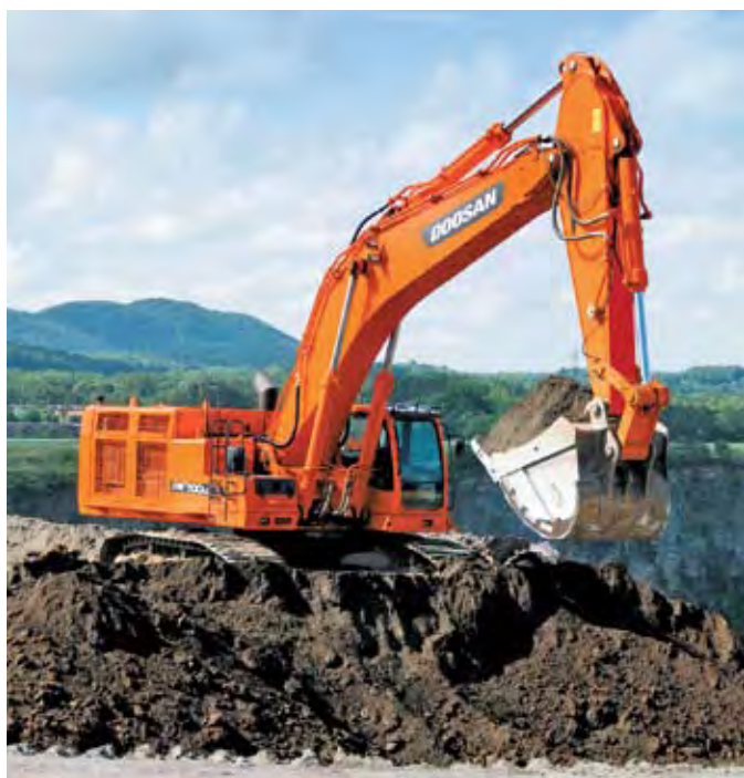
Escavadeira Doosan DX700LC, motor de 463 HP, 70 t
