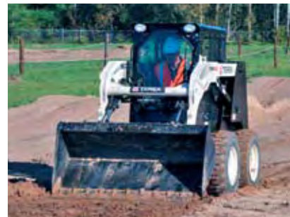
Linha de skid steer possui 8 modelos, de 50 a 83 HP, com elevação radial ou vertical da caçamba
