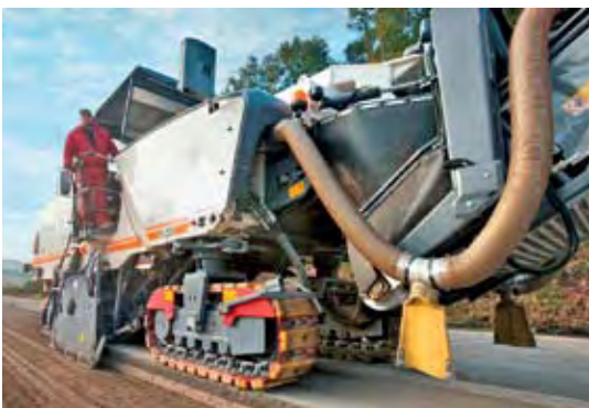
Sistema paralelo à superfície e bicos que captam os finos na fresadora W250
