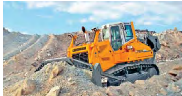
Trator de esteiras PR 764, de tração hidrostática
