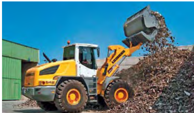
Novos modelos de carregadeiras com tração hidrostática, que consomem menos diesel
